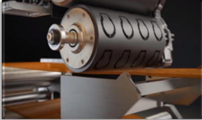
Eine Tonschicht wird auf einem Band gebildet
