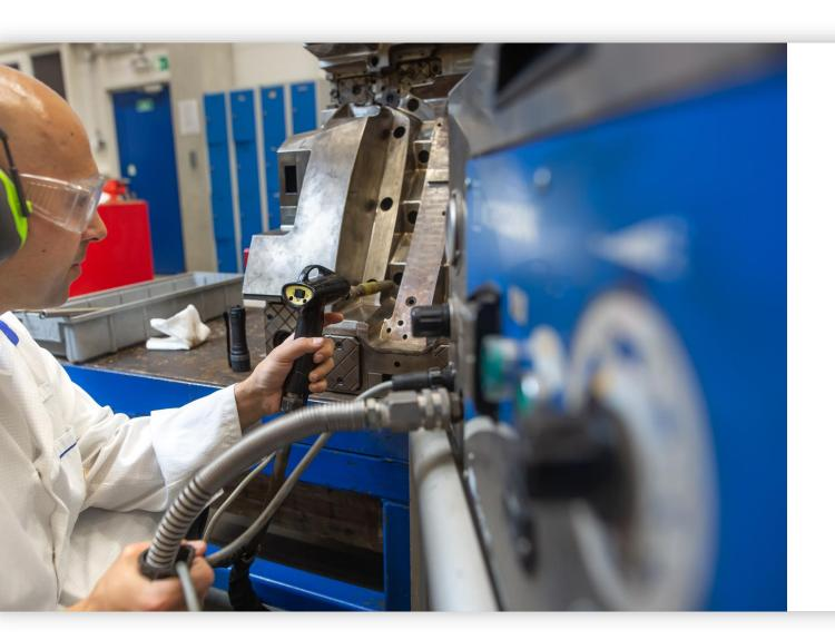
Beim FIM-Verfahren werden die Formen, in die das Material eingespritzt wird, durch Additive Fertigung aus speziellen Materialien produziert.
