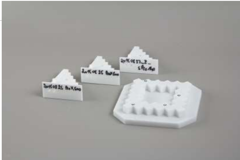
Kalibrierung der 3D-Drucker über Prüfkörper – Messung – Korrekturwerte
