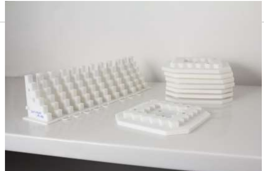
Kalibrierung der 3D-Drucker über Prüfkörper – Messung – Korrekturwerte
