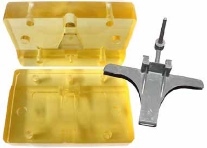
Silikonform: Der mehrstufige Prozess kommt bei kleinen Serien oder anspruchsvollen Prototypen zum Einsatz. (Bild: Alphacam)
